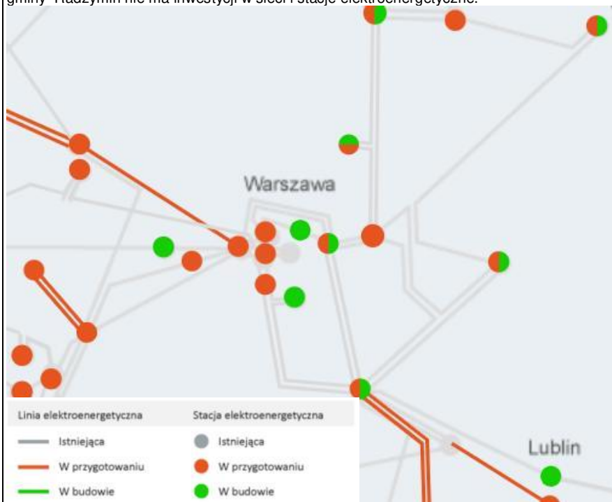
Ryc. Lokalizacja budowy linii i stacji elektroenergetycznych https://inwestycje.pse.pl/
