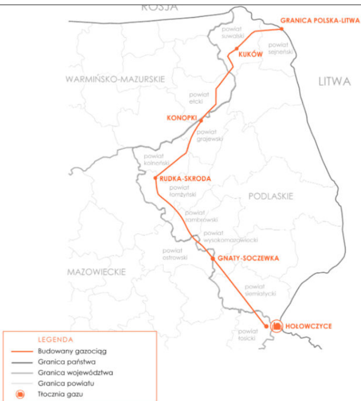
Ryc. Przebieg gazociągu Polska-Litwa. https://www.gaz-system.pl/pl/system-przesylowy/wsparcie-ue/inwestycje-zrealizowane-ze-srodkow-ue/polska-litwa.html
